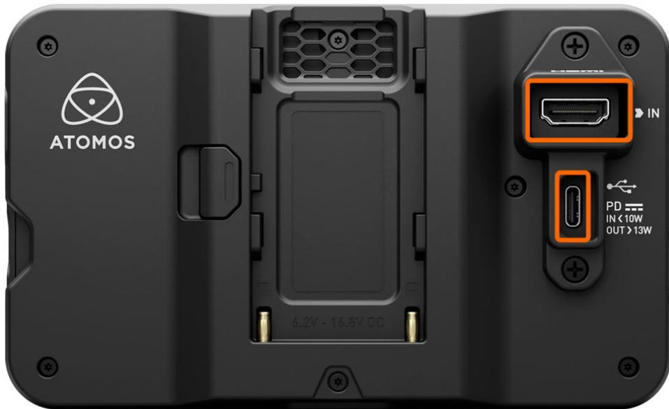
HDMIとUSB-Cポートの真上と真下には、2つのネジ山があります。これは、付属のロック式ケーブルアダプターを取り付けるためのものです。Atomosは様々なロック式HDMIケーブルを販売しており、このアダプターを使用することで、モニター側で誤ってHDMIが抜けるリスクを予防することができます。
