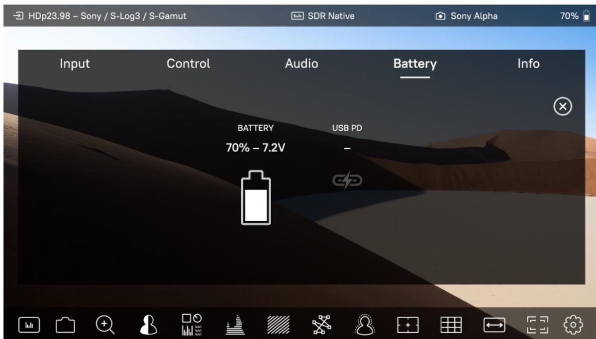
バッテリーメニューでは、トップメニューバーの右端に表示されるバッテリーインジケータ以外にも、いくつかの詳細が表示されます。
